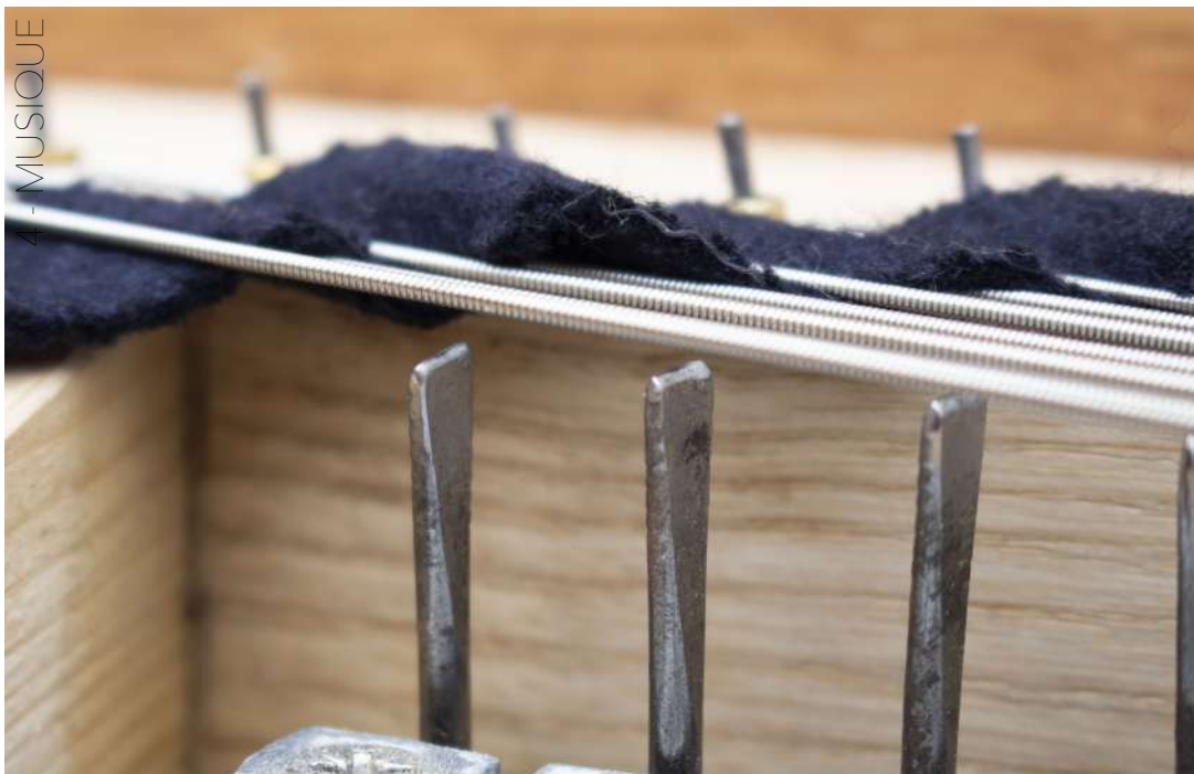
(Détail) Percuteurs et étouffoirs - acier, feutre, cordes de guitare électrique
