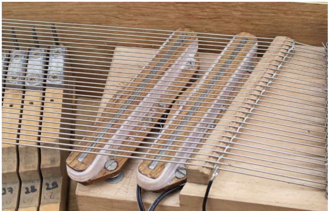
(Détail) Micros électromagnétiques sur mesure - acier, cuivre bobiné, noyer, ficelle, cire
